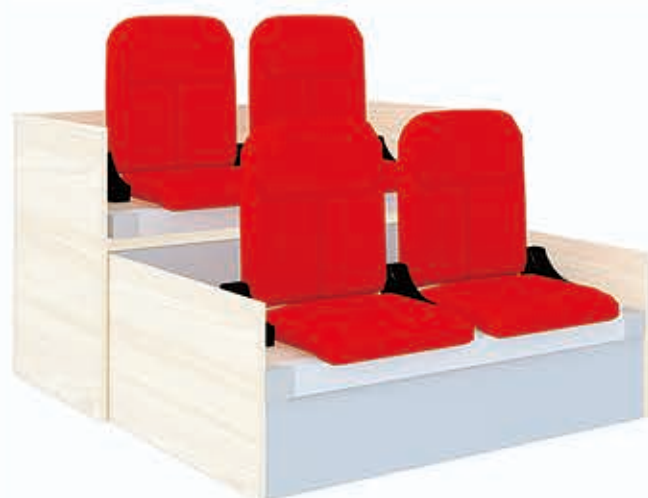
SJ-A031 前置软包翻板椅 层宽: 900mm 层高: 310mm 座椅类型: 前置软包翻板椅 座椅间距: 500mm 驱动方式: 手动或电动 座椅翻转方式: 手动或自动翻转
