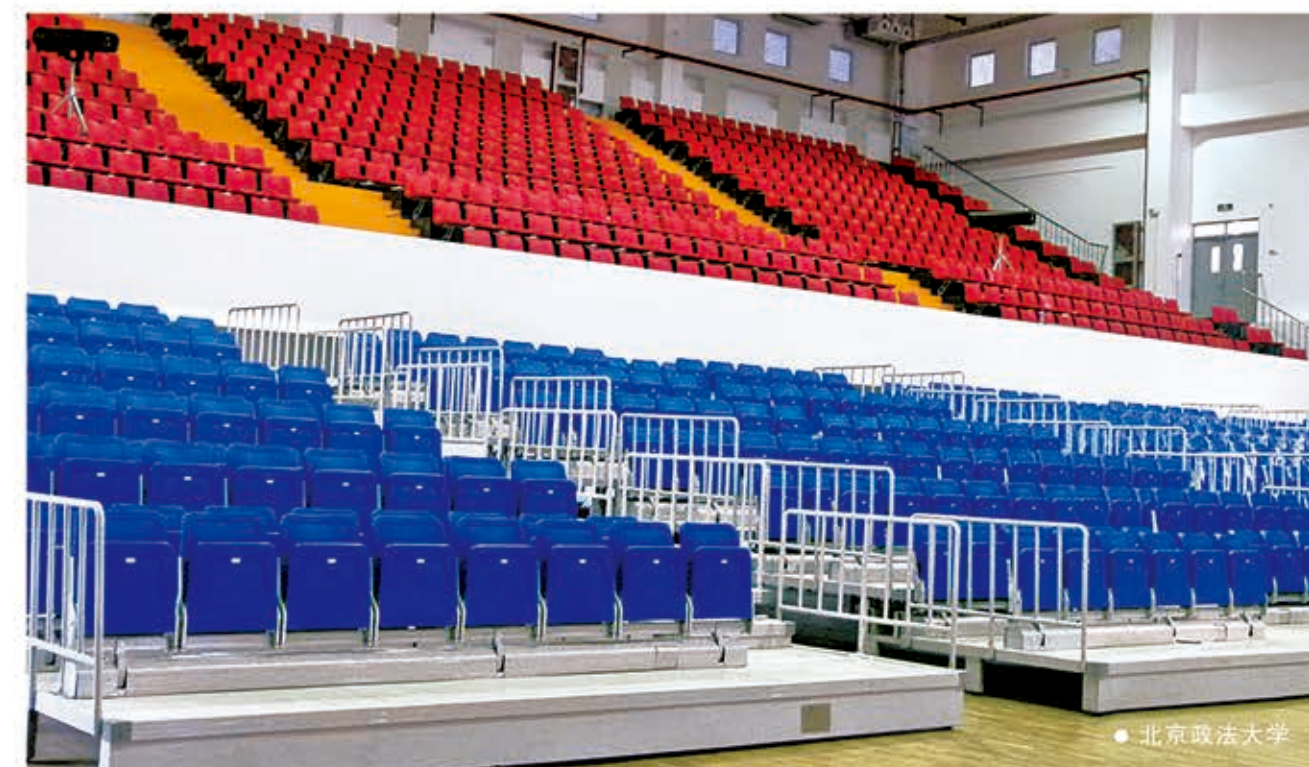
SJ-A033 后置式单层双排看台 层宽: 1700mm 层高: 330mm 座椅类型: 后置式塑料翻板椅 座椅间距: 500mm 驱动方式: 手动或电动 座椅翻转方式: 手动或自动翻转
